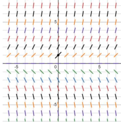
Figura: Campo de direções de  $y' = y$  (veja Desmos.com). Note que a solução particular  $y = e^x$  satisfaz  $y(0) = 1$
