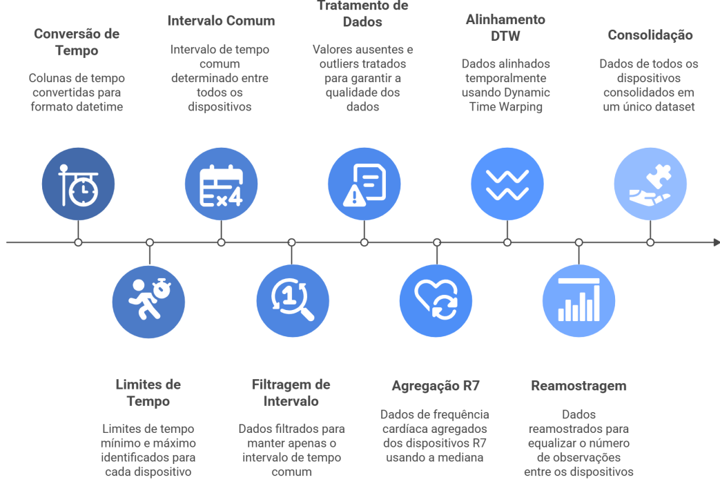
Figura 4: Pipeline de pré-processamento dos dados mostrando as etapas principais.
