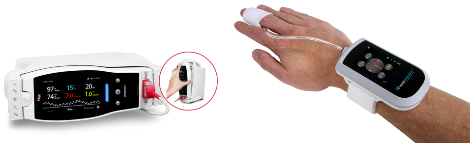
Figura 2: Aparelhos utilizados para a coleta de dados utilizada no projeto. Na esquerda, o aparelho R7, responsável pelos dados de oxigenação, perfusão e pulsação. Na direita, aparelho CT-B2B responsável pela pressão arterial e pulsação.
