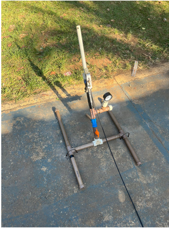
Figura 4: Base de lançamento dos foguetes em preparação para lançamento
