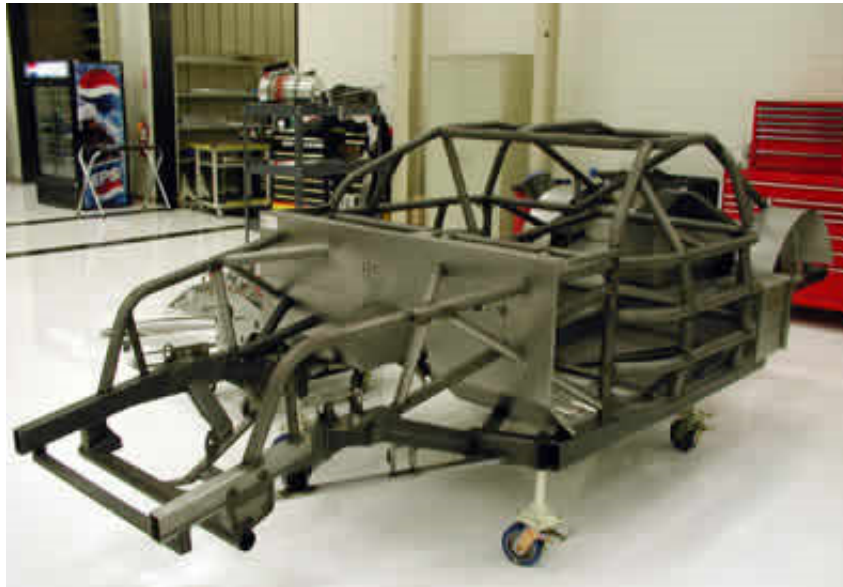
Figura 4: Estrutura com barras metálicas. Fonte: Google Imagens.
