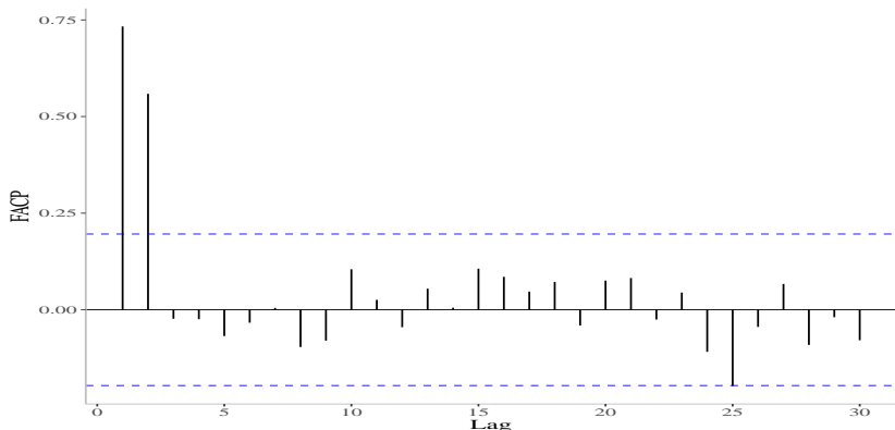
Figura: FACP para a série simulada de um processo AR(2) com \phi_1 = 0,3 , \phi_2 = 0,6 e considerando um ruído branco N(0,1) ( n = 100 ).
