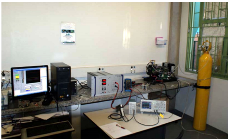
Figura 2. Laboratório para levantamento do comportamento estático e dinâmico da célula a combustível [8].
