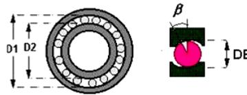
**Fig. 5.** Dimensões utilizadas para a determinação das frequências de falha de rolamentos
