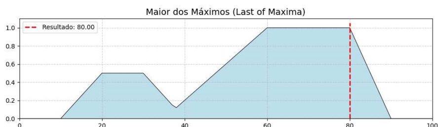
Figura 9: Ilustração da operação do método do maior dos máximos
