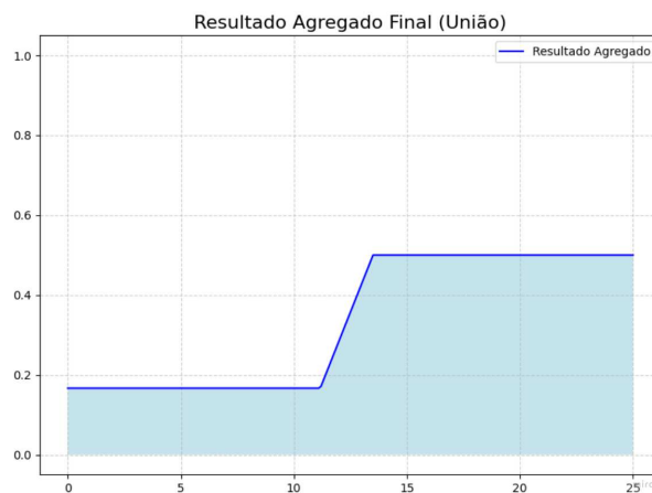
Figura 3: Conjunto fuzzy de saída agregado, formado pela união (operador máximo) das saídas individuais das regras.
