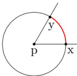
O comprimento do arco pode ser definido por um processo de aproximação (limite) por união de segmentos de retas cujas extremidades estão no arco.
